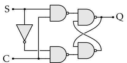
Dès que l'horloge passe à 1, la sortie est modifiée en fonction des entrées. Cette valeur sera verrouillée pendant un cycle d'horloge. On parle alors de **bascule**, comme la bascule D présentée ci-dessus.
