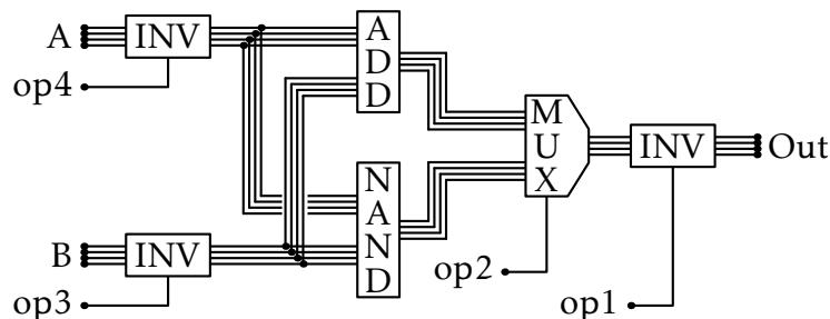
Les bits op4 à op1 correspondent au **code opération** (*opcode*). Ce code sert à déterminer le type d'opération effectuée par l'unité. Par exemple, avec le code 0000, l'unité réalise  $A + B$ , alors qu'avec 0010, elle réalise  $A \text{ nand } B$ .
